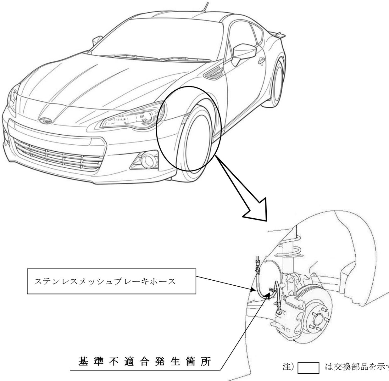
後付け用品のステンレスメッシュブレーキホースにおいて、固定金具付近に想定を超える応力が集中し、損傷することがある。そのまま使用を続けると、損傷が進行しブレーキ液が漏れ、ブレーキ警告灯が点灯し、最悪の場合、制動力が低下するおそれがある。
