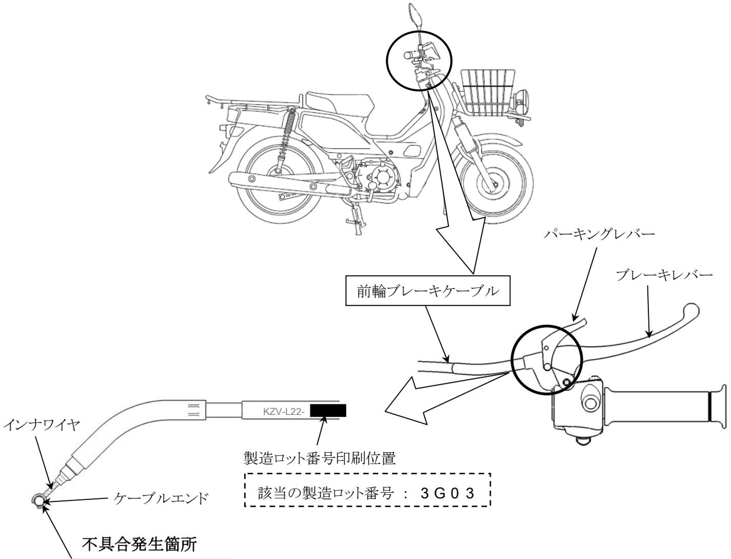
販売店オプション部品として設定し販売した寒冷地用前輪ブレーキケーブルを装着した車両において、ケーブルエンドへのインナワイヤ鑄込み位置が不適切なため、坂道などの駐停車時に使用するパーキングレバーの操作を繰り返し行くと、ケーブルエンドが破損し、前輪ブレーキが利かなくなるおそれがある。
