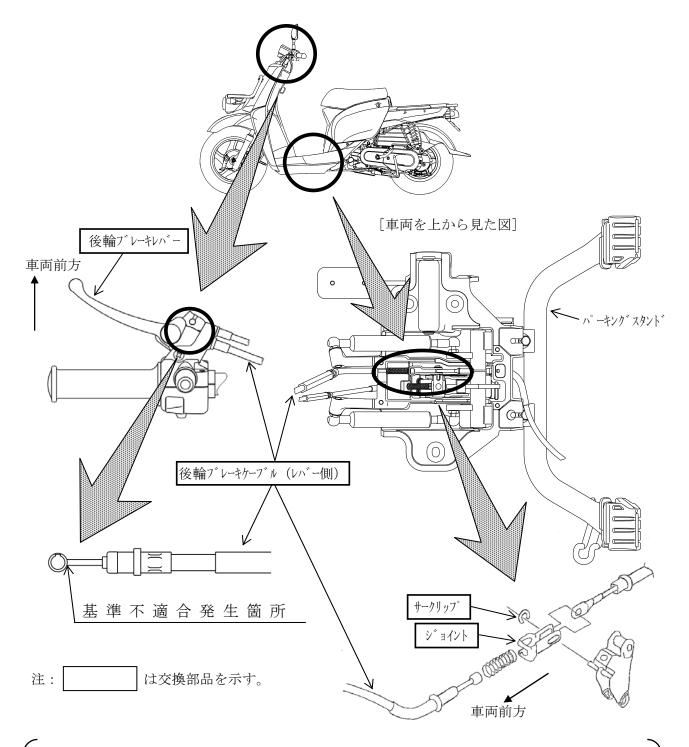
パーキングスタンド(後輪を接地させたまま車体を保持するためのスタンド)を上げ下ろしするための構造において、設計が不適切なため、後輪のブレーキレバーを強い力で最大引き量またはその近くまで握らないとパーキングスタンドが下ろせない。そのため、パーキングスタンドを使用するたびに、後輪のブレーキケーブルが過度に引っ張られ、使用過程において、当該ケーブルが切損し、後輪ブレーキが利かなくなるおそれがある。
