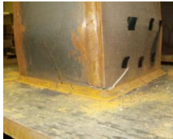
最終破壊状況 (B/t=20, 0-0.6変動軸力の試験体)
