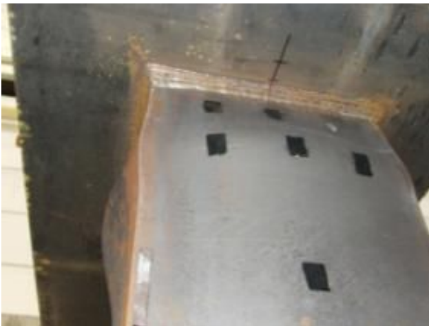
最終破壊状況 (B/t=20, 0-0.6変動軸力の試験体)
