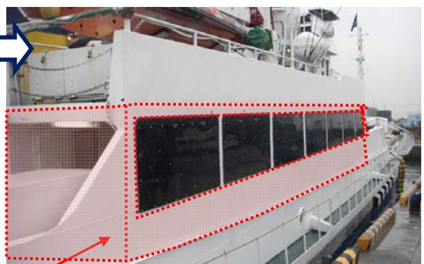
甲板室の開口部をアクリル板にて閉鎖。これにより、船舶の閉囲場所（着色部の容積）が増加し、トン数が増加する。
