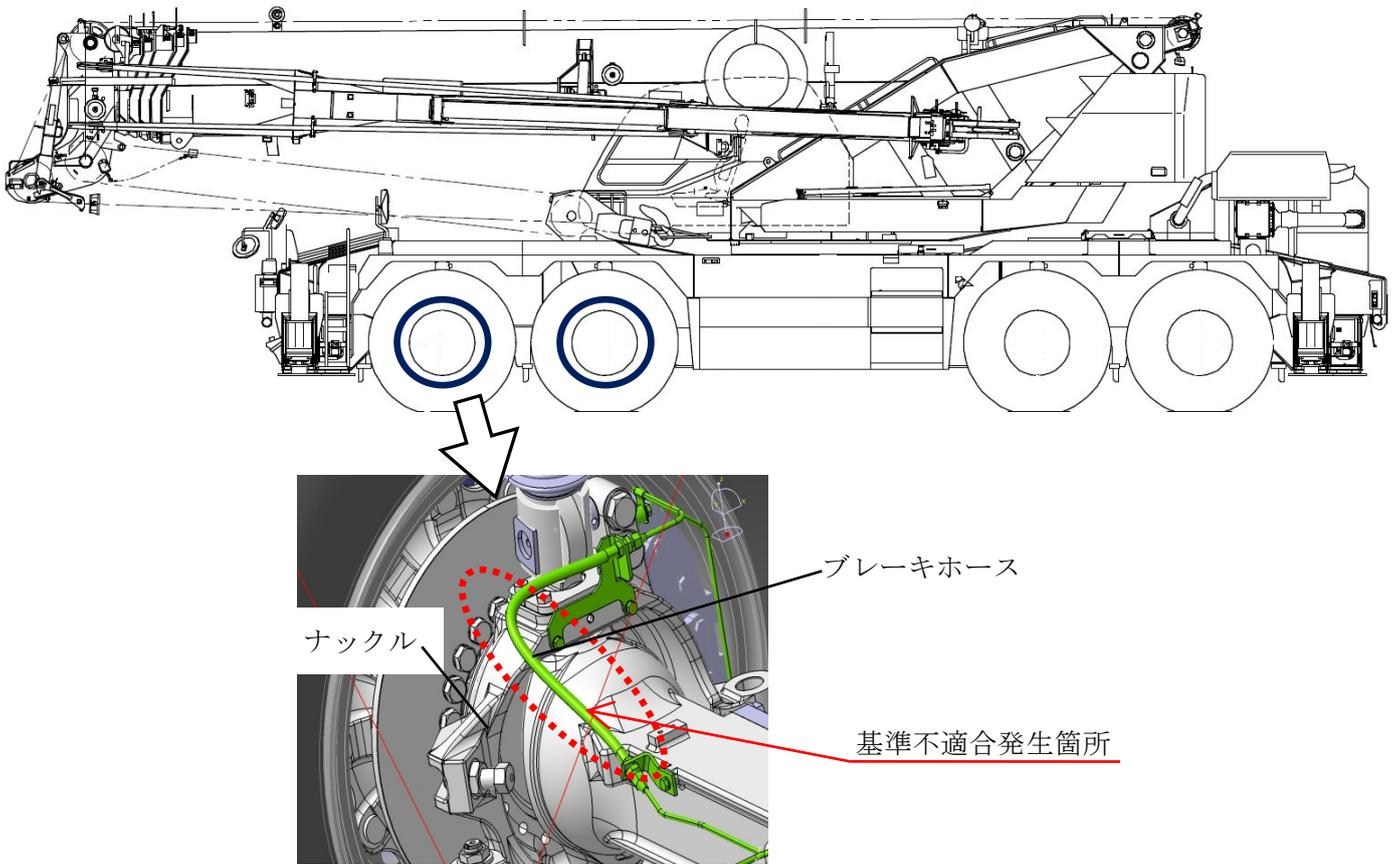
ホイール・クレーンの制動装置において、ブレーキホースの取り回しが不適切なため、ハンドル操作をした際にハンドルのリンク機構がブレーキホースに接触するものがある。そのため、そのままの状態で使用を続けると、ブレーキホースが損傷し、ブレーキ液が漏れて制動力が低下するおそれがある。
