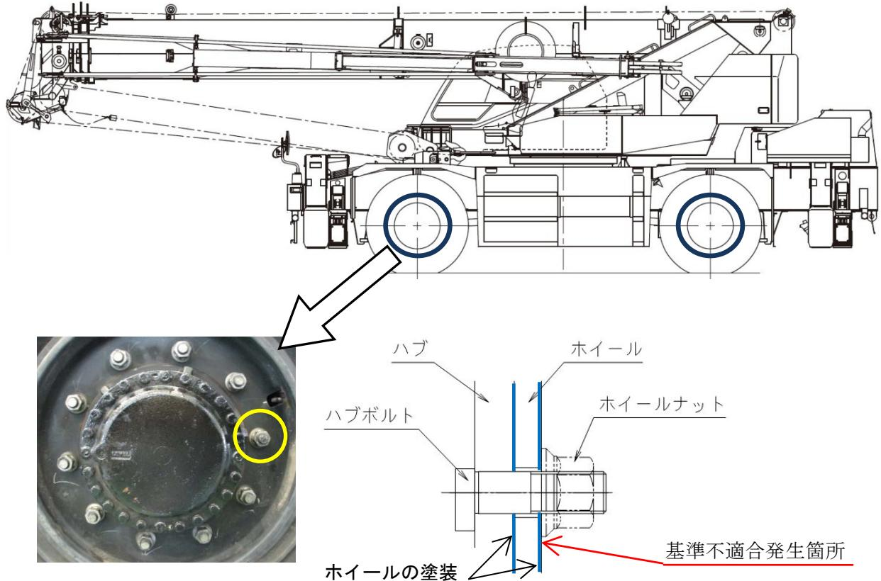
〔 ホイール・クレーンの走行装置において、ホイールディスクの塗装厚さ及び製造時のホイールナットの締付けが適切なものがある。そのため、そのまま使用を続けると、走行中の振動等によりナットが緩むおそれがある。 〕
