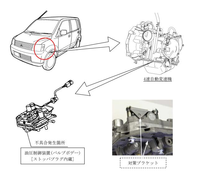
4 速自動変速機の油圧制御装置(バルブボデー)において、ストッパプラグの材質が不適切なため、高速走行や登坂走行等の高油温時の変速動作により、当該ストッパプラグが破損する場合がある。そのため、適正な油圧が保てず、変速ショックや変速不良が発生し、後退不能となるおそれがある。
