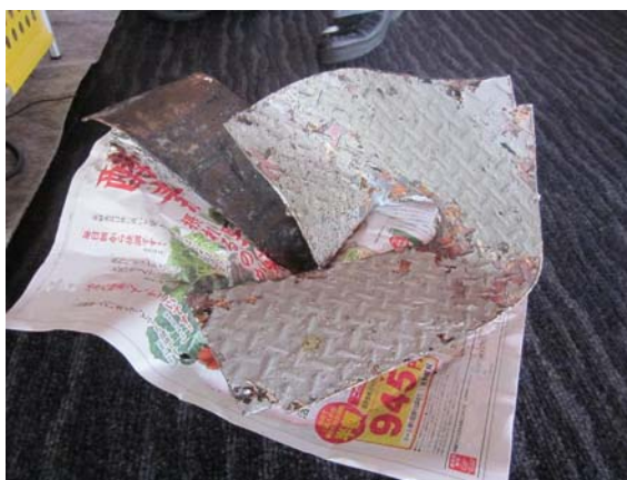
写真3. かご内に舞い込んだ縞鋼板
