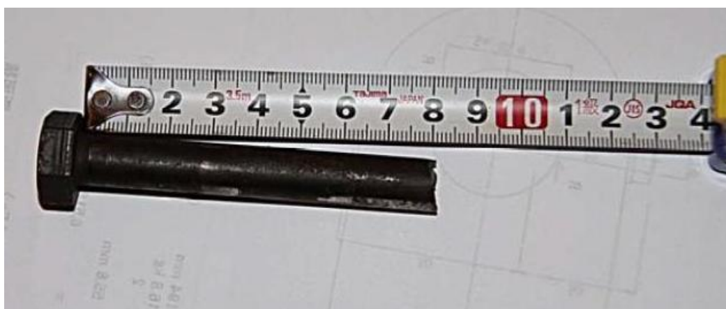
写真5. 破断したボルト
