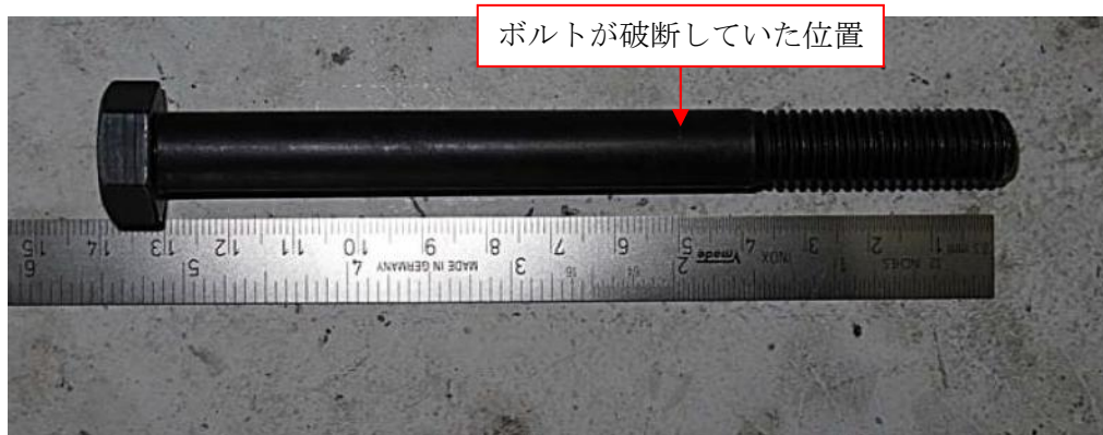
写真4. 破断したボルトと同仕様のもの
