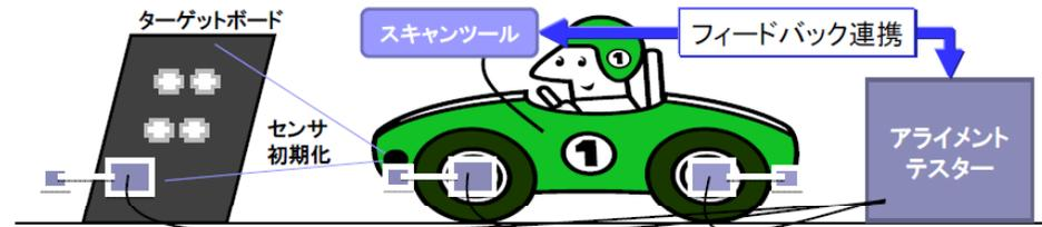
アライメントテストにて車両アライメントを確認し、それに応じた正しい位置へターゲットボードを設置 ⇒ スキャンツールにて初期設定
