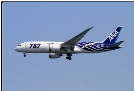
ボーイング787-8 座席数264席 全幅60.1m 全長56.7m 航続距離9,930km
