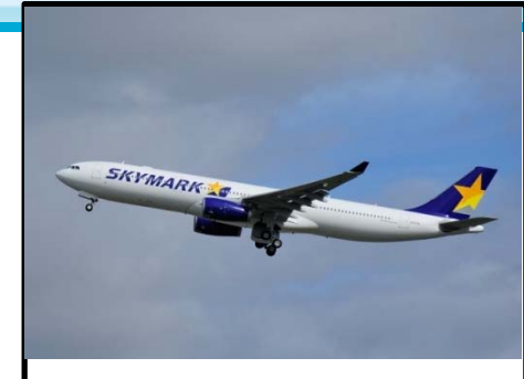
エアバスA330-300 座席数295席 全幅58.6m 全長62.6m 航続距離9,250km
