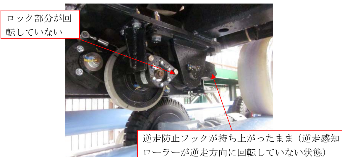
写真4. 事故時の逆走防止装置の状態
