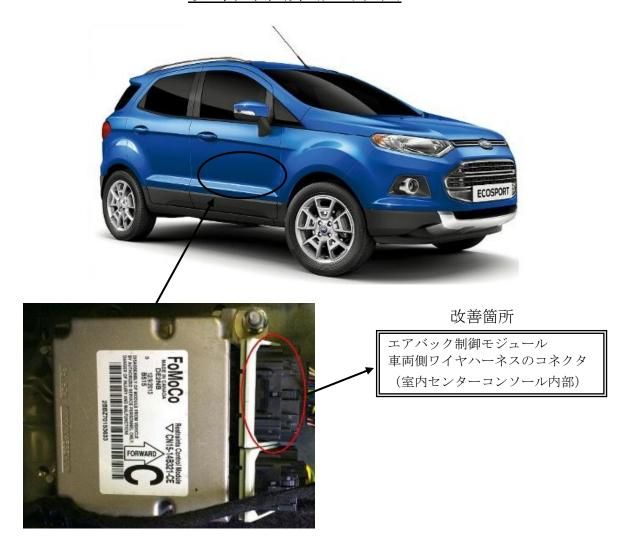
不具合発生個所:車両ハーネス側コネクタ部(端子の誤組み付け)
