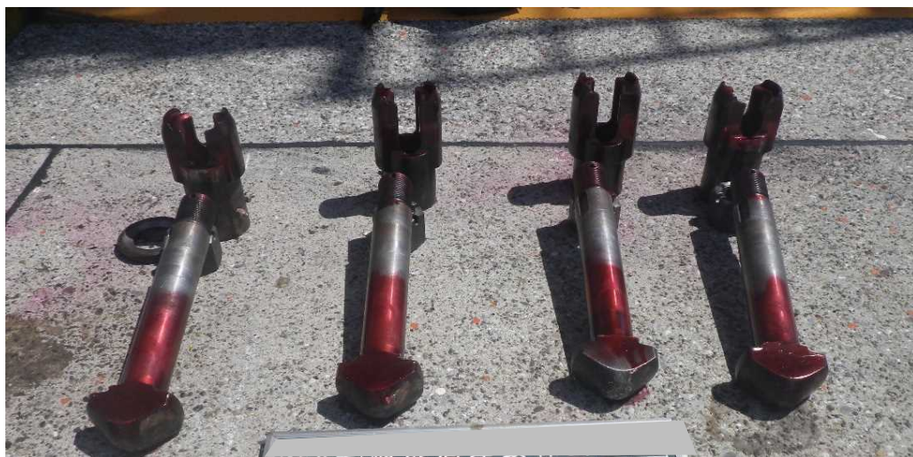
検査用浸透液（赤色）の塗布
