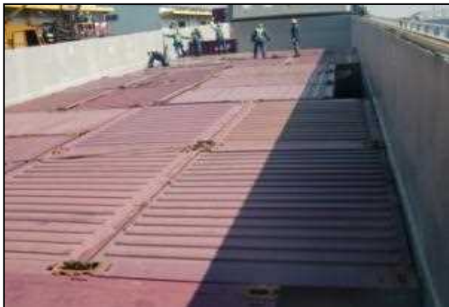
積木を組み合わせるように隙間なく艙内に積込
