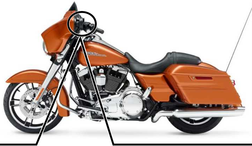
不具合箇所 制動装置 (クラッチマスターシリンダー)
