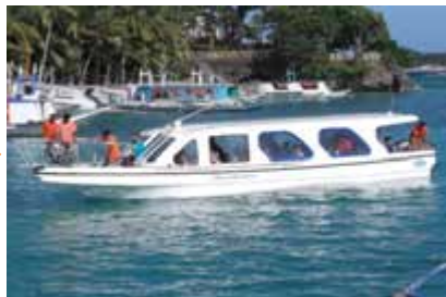
旧式木造船（アウトリガーによる横転防止） 利便性や安定性に優れたFRP製ボート
