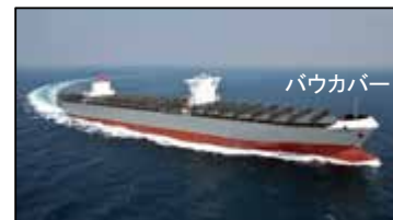
14,000個積み 超大型コンテナ船 “MILLAU BRIDGE” 全長 365.94m, 幅 51.20m, 深さ 29.90m
