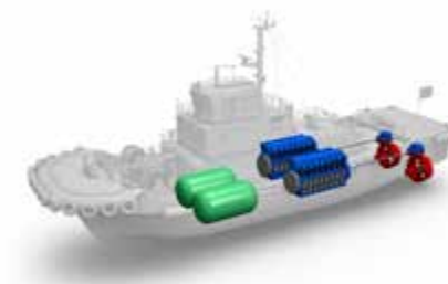
我が国初の天然ガス燃料船(日本郵船タグボート)
