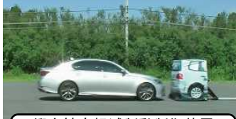
衝突被害軽減制動制御装置性能試験
