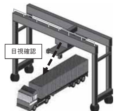
オペレーターがコンテナ上部 に表示されているコンテナ番号等 を目視確認で判別
