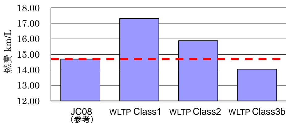
図2 Class2 が適用される車両(最高速度 120km/h 以上)における各サイクル(超高速フェーズは除外)での燃費試験の結果の例
