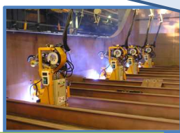
3次元CADと連動した加工自動化
