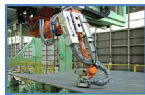
3次元CADと連動した加工自動化
