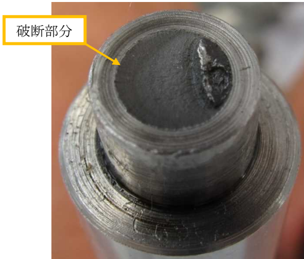
写真6 破断部分（上部側）
