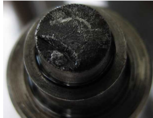
写真7 破断部分（下部側）
