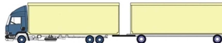
タイプ3: 全長25.25mまでの、台車軸および被牽引車を伴う貨物車
