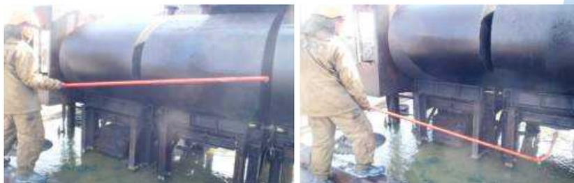
※アプリケーションノズルがない場合は、消火ノズルの放水形状を噴霧放水に切り替えて代用する
