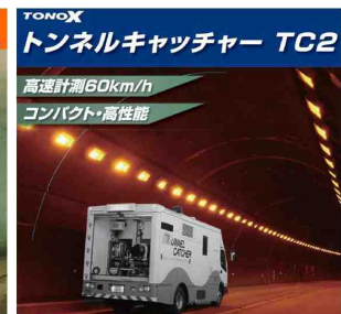
トンネル覆工表面調査 (レーザー計測)
