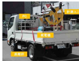
3次元形状計測カメラ 6台
