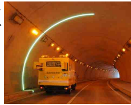
ひび割れ評価、損傷箇所抽出
