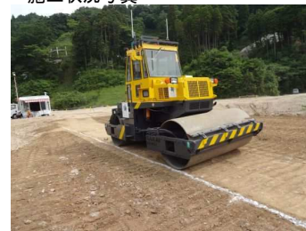
自律制御型振動ローラー
