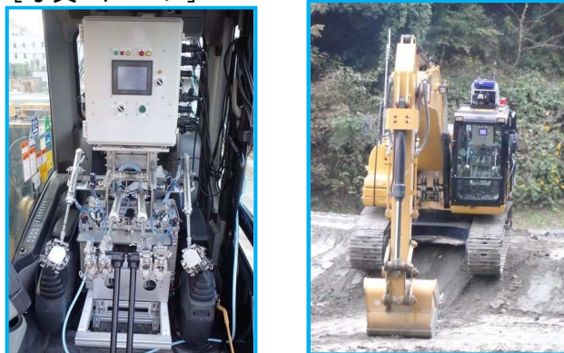
ロボQ II 運転席搭載状況
