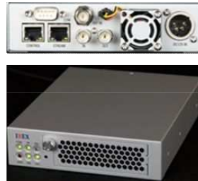
今回開発した低遅延型デジタル高精細画像システム
