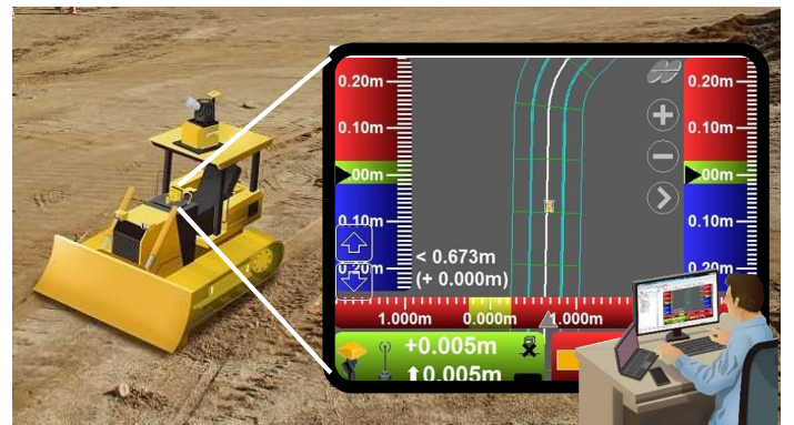
搬入経路を見ながら遠隔操作による走行検証
