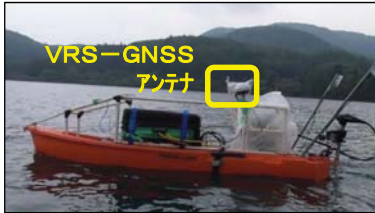
ASV (Autonomous Surface Vehicle); 自動航行式ボート
