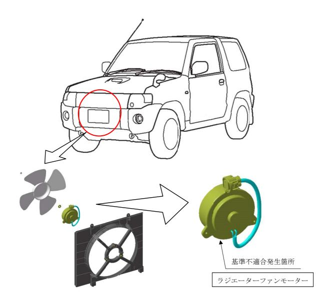
ラジエーターファンモーターにおいて、ブラシの材質が不適切なため、ブラシが吸湿して膨張することにより、接触不良となり、ラジエーターファンモーターが停止することがある。そのため、エアコンの効き不良や冷却水の水温上昇が生じ、そのまま使用を続けると、オーバーヒートやエンストに至るおそれがある。
