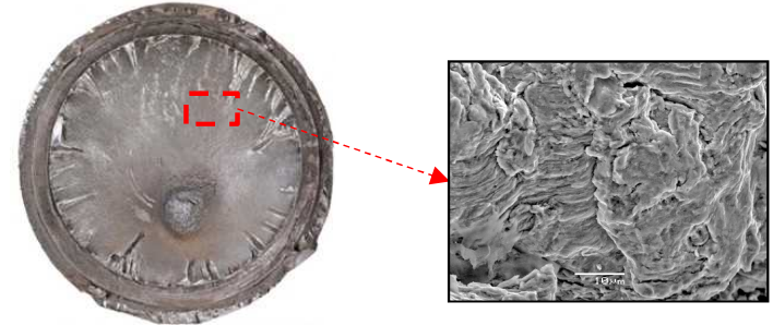
(a) 全体 写真3 主軸・フランジ溶接部断面 (b) 拡大
