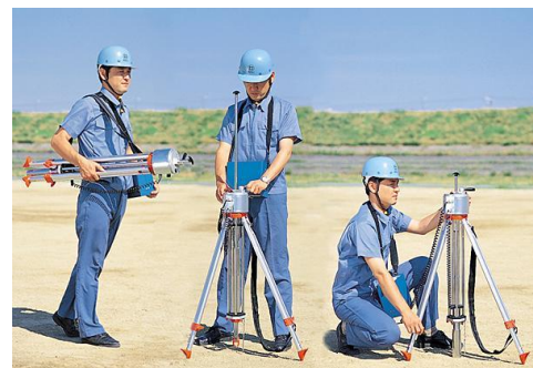
写真一 3 キャスポールの移動、測定、設置
