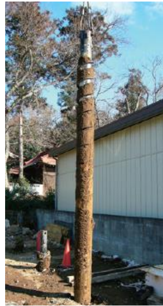
図一1 回転貫入・支持力発現機構（左図）と載荷試験後に引抜いた杭体（右写真）
