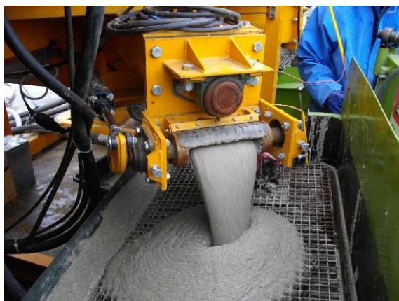
写真—1 流動性を付与し圧送可能にした砂
