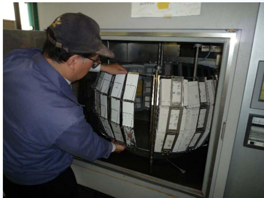
仕上材の劣化促進 (紫外線劣化促進機)
