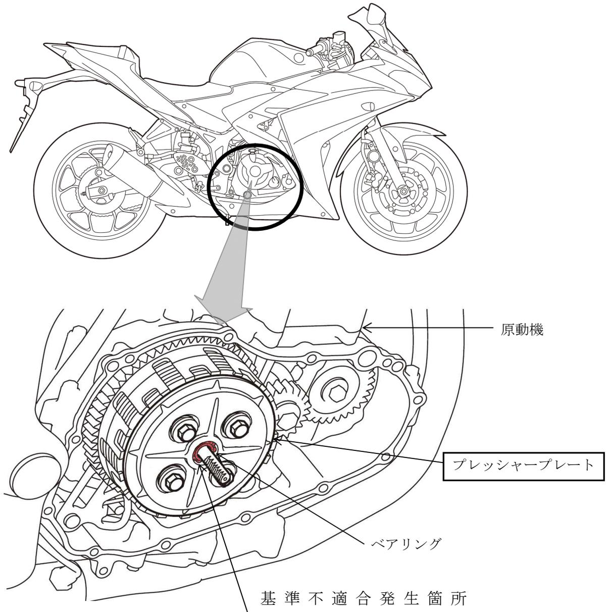
動力伝達装置において、クラッチプレッシャープレートのベアリングの強度が不足しているため、クラッチ操作を繰り返すと、当該ベアリングが破損することがある。そのため、クラッチが切れず変速ができなくなり、走行不能となるおそれがある。
