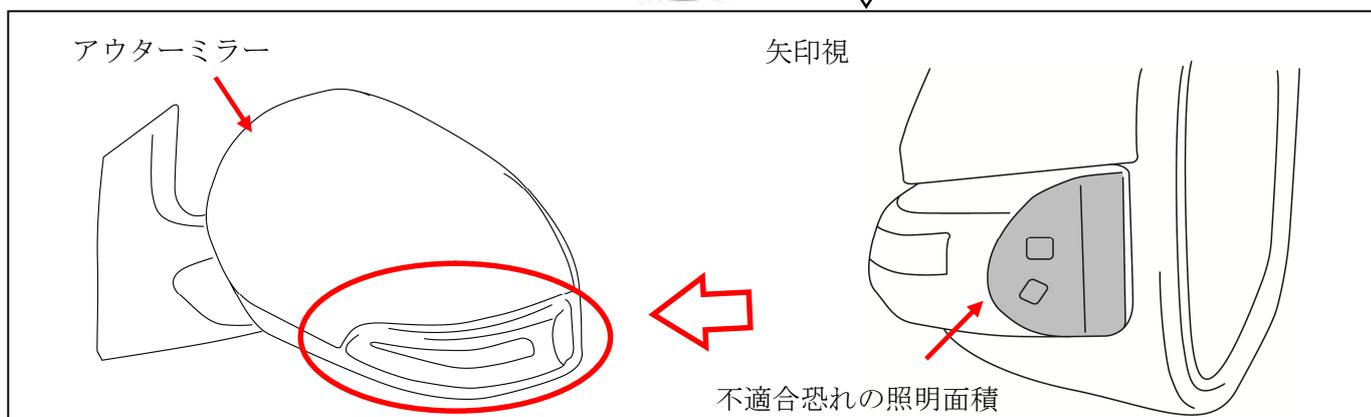
後付け部品として販売した LED マルチファンクションドアミラーにおいて、両側面に備える方向指示器の照射部の面積が、不足しているため、保安基準に適合していない。
