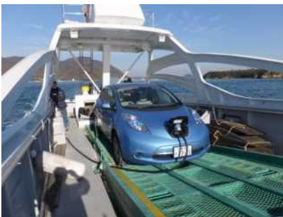
図6 海上航行でのEV充電試験
