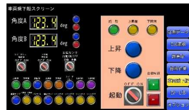
図5 乗下船装置自動制御システムの操作画面
