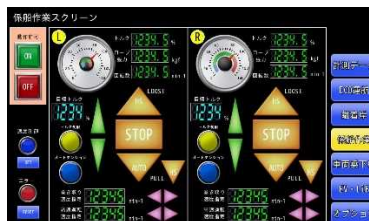
図4 係船作業支援システムの操作画面
