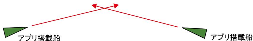
赤線は対地速度による5分後の到達位置と進行方向を示しています。「速力方位ベクトル線」この線を読み解くことで、回避行動が可能かを確認を致します。
