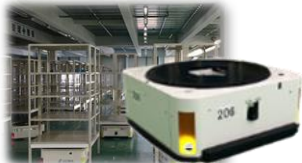
(例) 物流施設においてAIにより制御された無人搬送車が保管棚を運搬
