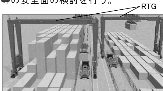
RTGの遠隔操作化導入後のイメージ
