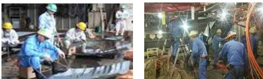
船舶は単品で受注・生産するため、自動化が難しく、現状では平板切断や直線溶接のみ自動化。
