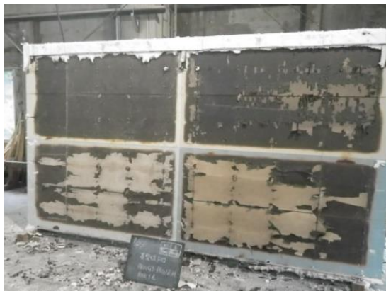
解体後の試験体 (下張りGB表面)
