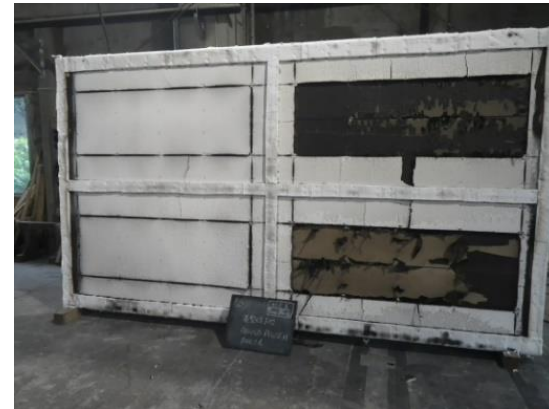
加熱後の試験体
