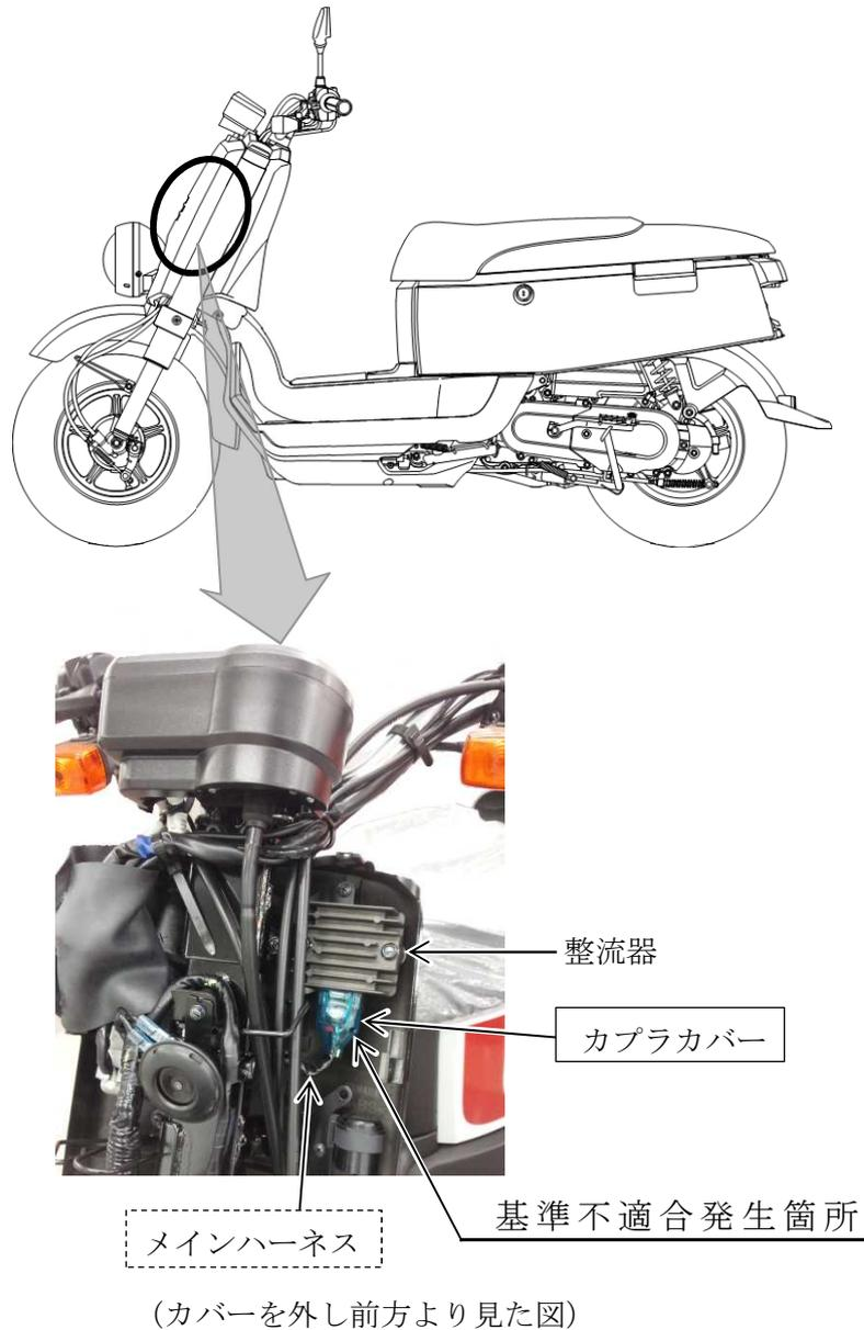
メインハーネスにおいて、配索のバラツキにより、洗車等の水が整流器に接続するカプラカバー内に溜まり、電気配線が腐食することがある。そのため、そのまま使用を続けると腐食が進行し、電気配線が断線して充電できず、警音器や方向指示器等の灯火器類が正しく作動しなくなるおそれがある。また、走行中にエンジンが停止して再始動できなくなるおそれがある。
