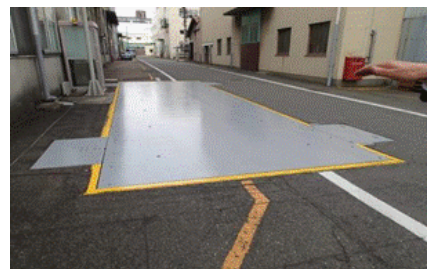
トラックスケール（床下ピット式）
