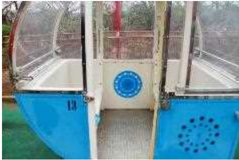
写真5 通気回転窓の設置位置
