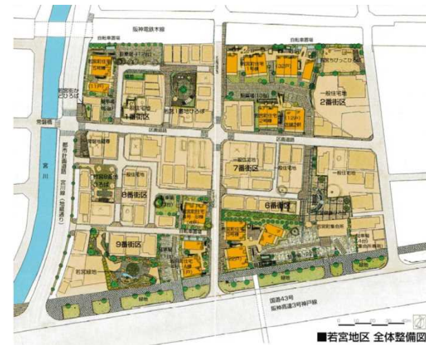
部分修復による復興まちづくり事例(若宮地区 / 兵庫県芦屋市) 阪神淡路大震災からの震災復興として、既成市街地の密集市街地における既存家屋に配慮し、被害エリアを限定して部分的な修復を行ったまちづくり実施例 出典: 公益社団法人都市住宅学会 HP
