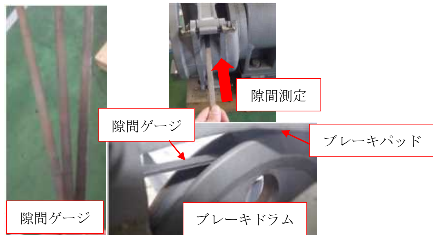
写真8 ブレーキパッドの摩耗確認
