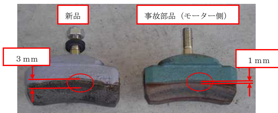
写真4 新品と事故部品のブレーキパッド比較
