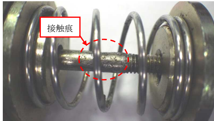
写真5 跳止めボルト側面の接触痕
