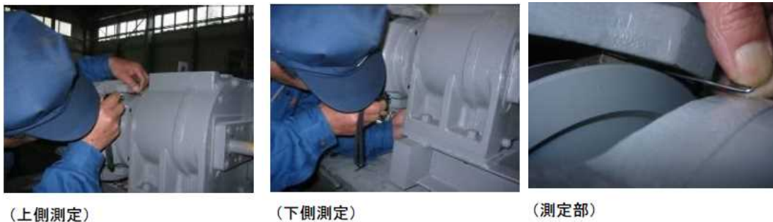
図4 ブレーキパッド摩耗確認方法 (三栄製作所の点検マニュアルより抜粋)
