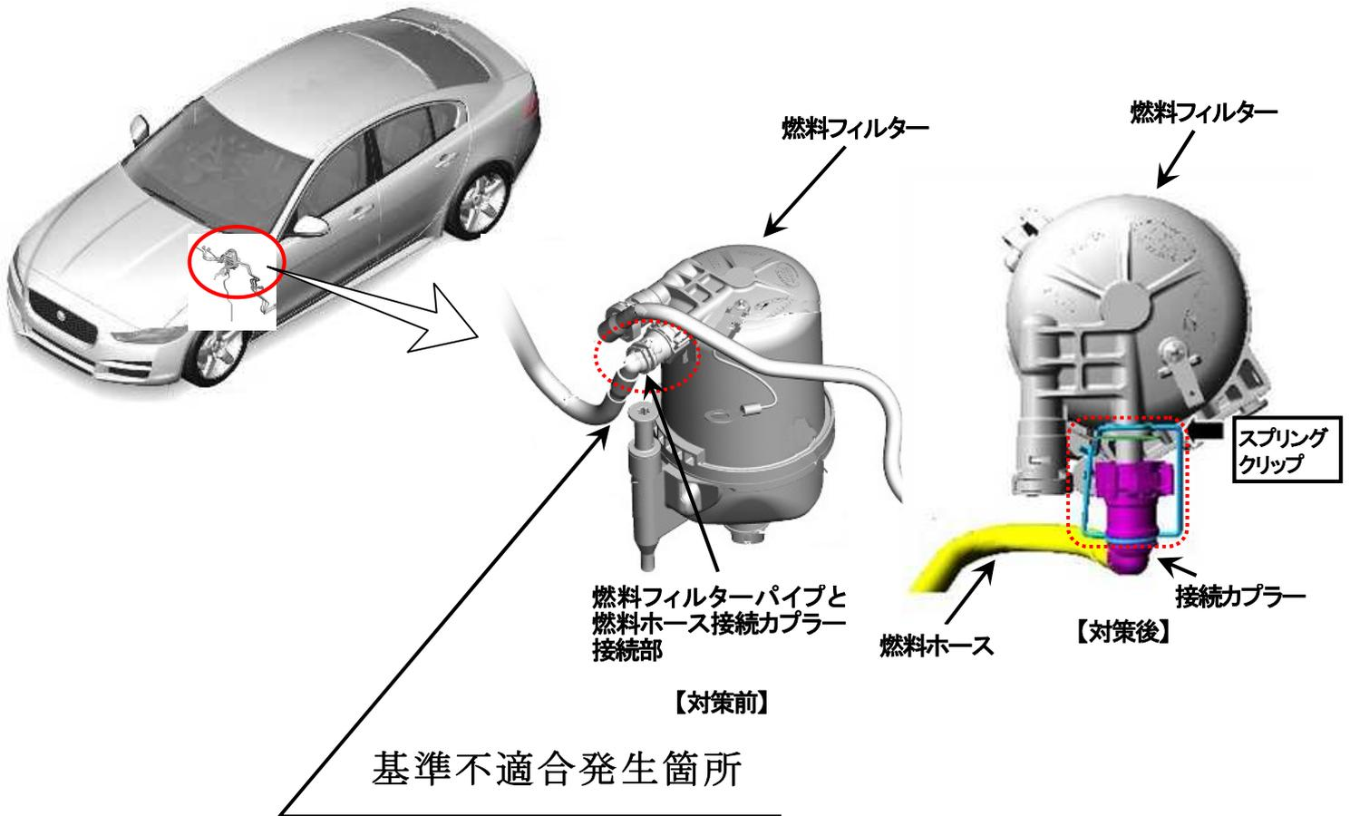
燃料装置において、燃料フィルターの振動に対する評価が不十分なため、燃料ホース接続部がエンジン振動等により磨耗することがある。そのため、そのままの状態で使用を続けると、当該接続部の磨耗が進展し、燃料ホースが外れて燃料が漏れ、燃料供給ができず、最悪の場合、走行中にエンジンが停止し、再始動できなくなるおそれがある。
