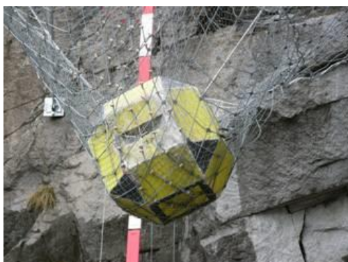
写真三 実物大性能確認試験（重錘捕捉）
