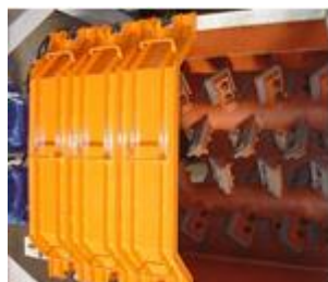
密閉型混合槽の上部の蓋を一部開いた状態
