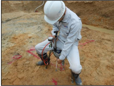
写真-1 試験機(約8kg)に座り試験している状況
