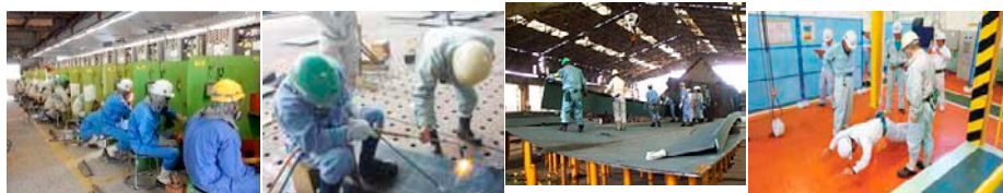
研修の様子（溶接、ぎょう鉄（曲げ加工）、船殻組立、
