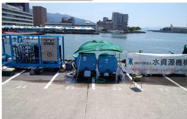
(可搬式浄水装置1号機)
